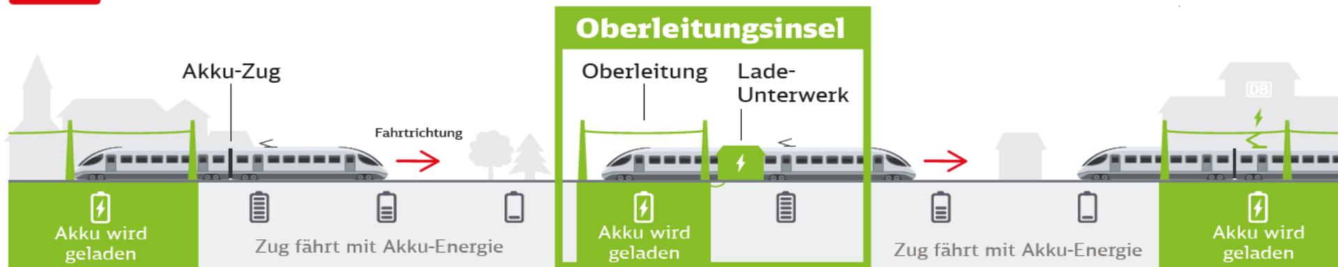
**Oberleitungsinseln erschließen neue Möglichkeiten für mehr klimaschonenden elektrifizierten Bahnverkehr in ganz Deutschland.**
